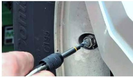
2. Arbeiten Sie mit dem Gewindebohrer und dessen Windeisen wieder das Gewinde ein.
