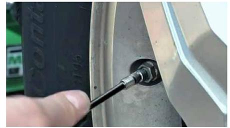
3. Bringen Sie das ReCore-Ventil wieder mit Hilfe der Ken-Lok® Schraubensicherung an und schrauben Sie es mit dem Ventileinsatzschrauber mit voreingestelltem Anzugsmoment ein.
