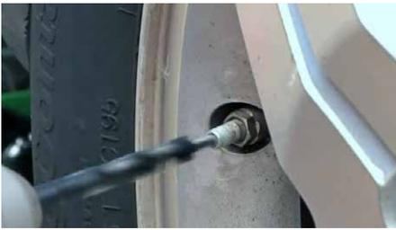
1. Legen Sie den korrodierten Ventileinsatz mit dem abgesetzten Bohrer bei hoher Drehzahl frei.
