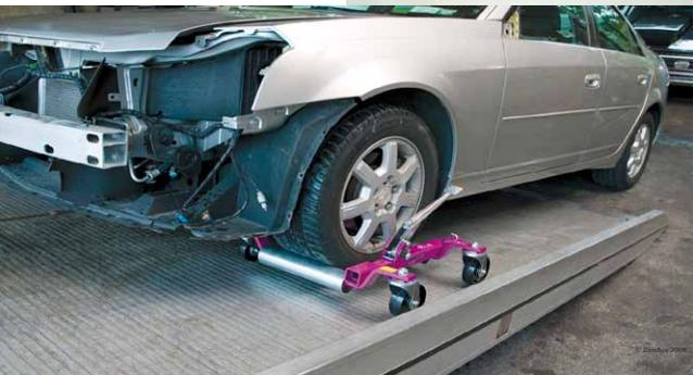
**GOJAK** fonctionne sur le principe d'un levage par une crémaillère bidirectionnelle commandée par une pédale. A chaque coup de pédale, les rouleaux placés sous la roue se rapprochent et la soulèvent progressivement en roulant sous le pneu. Une fois décollé du sol, le véhicule ne repose que sur les roulettes des chariots GOJAK. Cette conception mécanique ne demande aucune autre source annexe d'énergie.
