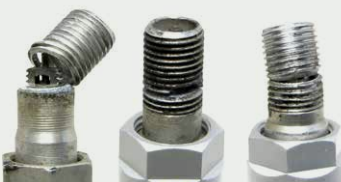
Válvulas de TPMS dañadas por corrosión galvánica
