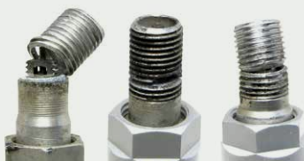
Válvulas de TPMS dañadas por corrosión galvánica
