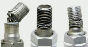
Valvole del sensore TPMS danneggiate da corrosione galvanica
