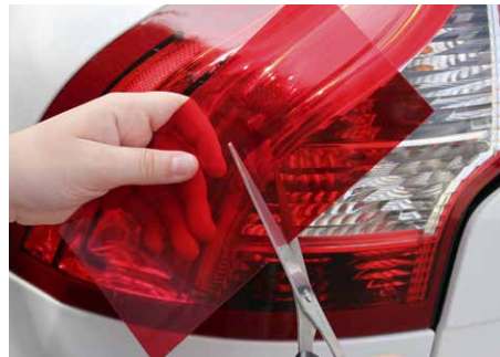
Couper le panneau de réparation Cut repair panel Tagliare il pannello di riparazione
